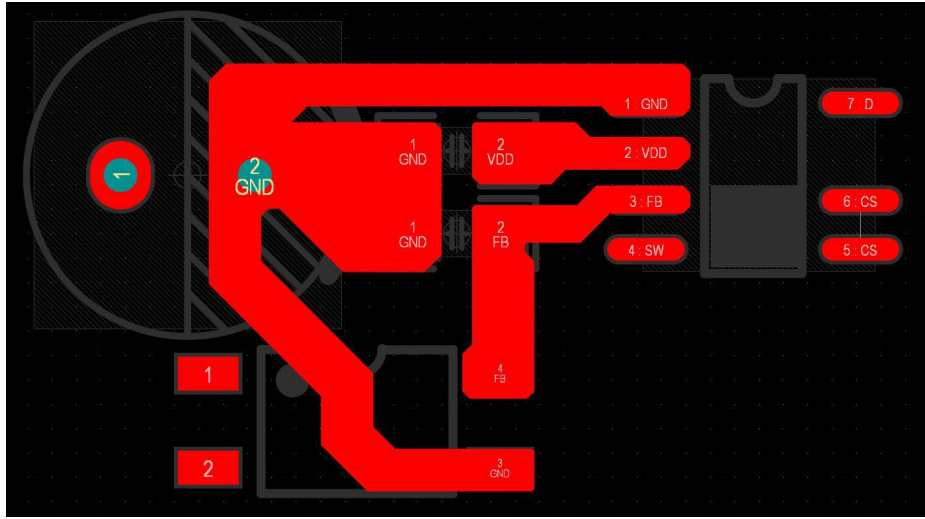
FB Layout 注意经过电容,FB电容尽可能靠近芯片FB_pin。GND Layout 注意分离。
