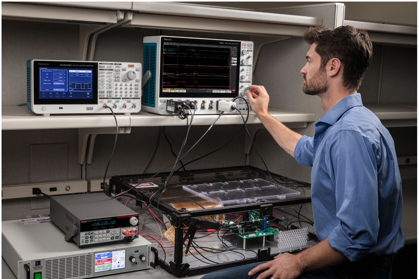
图 13：用于测试 SiC 低侧 FET 的双脉冲测试设置，包括带有双脉冲测试应用程序的 MSO58B 示波器、AFG31252 任意 / 函数发生器、用于 V_{DD} 的 PSB 11500-06 1.5 kW 直流电源，以及用于供电栅极驱动器的 Keithley 2231A-30-3 三通道电源。TICP0100 隔离电流探头通过分流电阻测量漏极电流。TCP0030A 钳式电流探头用于测量电感电流。在此设置中，低侧 FET 的源极接地，允许使用接地参考探头。TPP0850 高压无源探头连接到 V_{DS} ，带有 MHCX 插头的 TPP1000 无源探头连接到 V_{GS} 。
