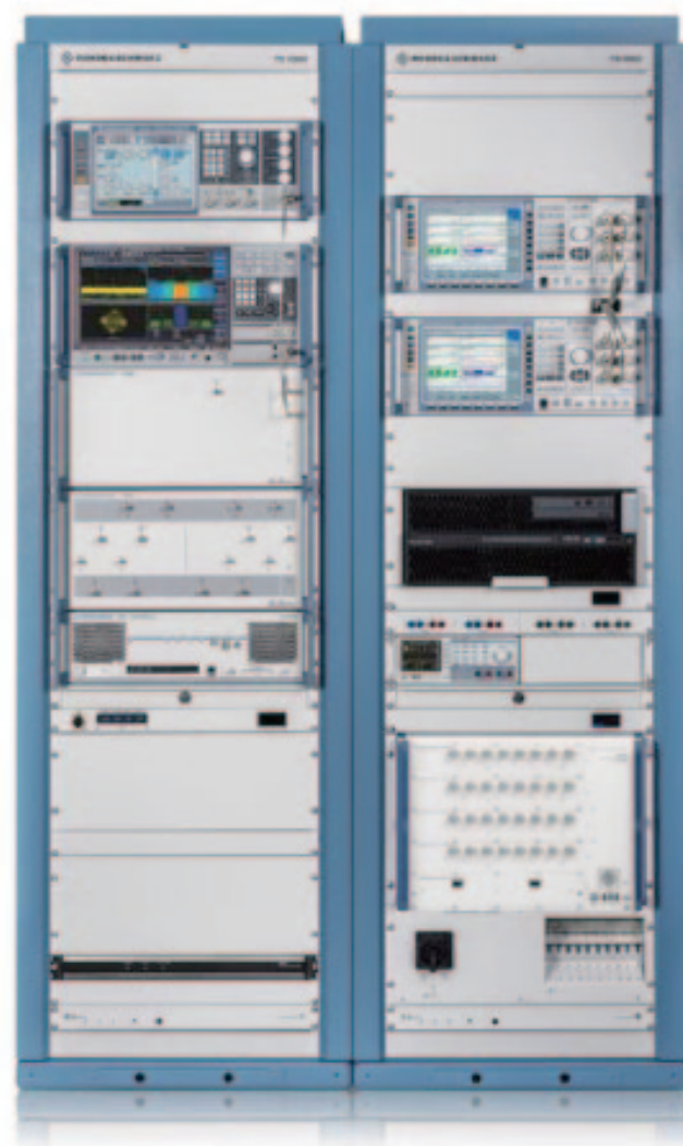
图 R&S®TS8980FTA-3A RF/RRM一致性测试环境
