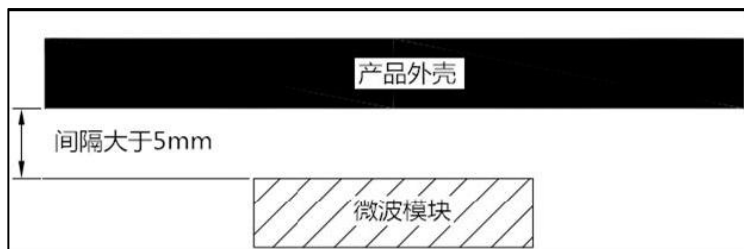
图 1: 外壳安装示意图
