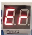
**注：**一键开锁执行过程中检测到某一个或多个锁通道发生短接时，状态反馈开锁失败，不单独反馈短路状态，详见 4.2.4。
