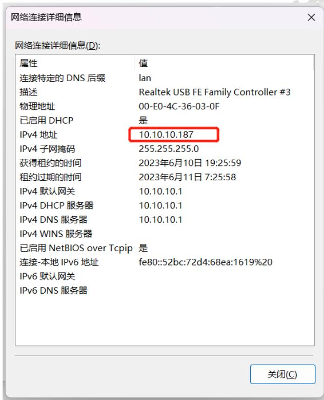
然后电脑上打开TCP调试助手工具，设置电脑为TCP SERVER 并设置IP为获取到的IP 10.10.10.187 端口号为3000这个是可以自定的如下图
