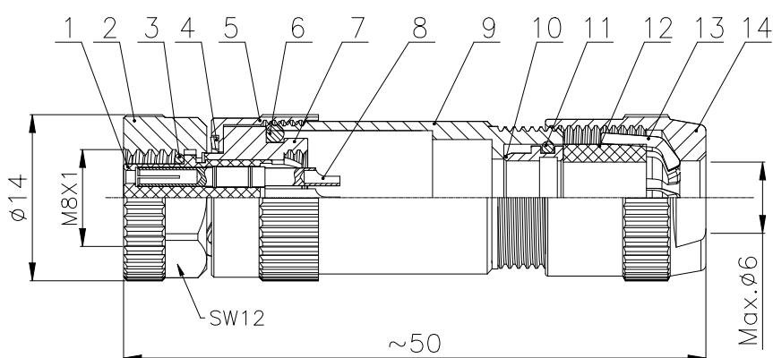
连接方式: 螺纹连接 外壳材料: 铜, 镀镍
