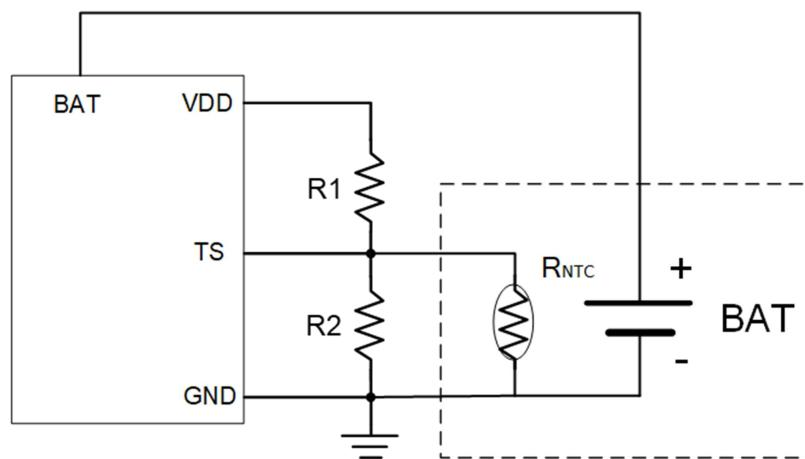
WSCH6056 将 TS 管脚的电压同芯片内部的两个阈值 OTPL 和 OTPH 相比较, 以确认电池的温度是否超出正常范围。在 WSCH6056 内部, OTPL 被固定在  $45\% \times VDD$ , OTPH 被固定在  $80\% \times VDD$ 。如果 TS 管脚的电压  $V_{TS} < OTPL$  或者  $V_{TS} > OTPH$ , 则表示电池的温度太高或者太低, 充电过程将被暂停; 如果 TS 管脚的电压  $V_{TS}$  在 OTPL 和 OTPH 之间, 充电周期则继续。
