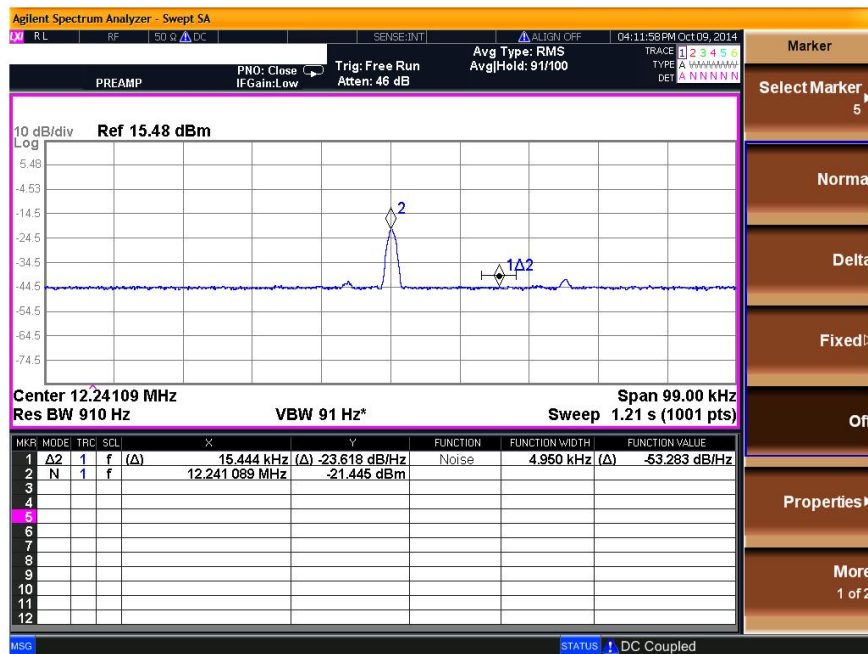
图 2 RX 通道噪声系数，输入-114dBm,NF 为 5.8dB（线损 1dB）
