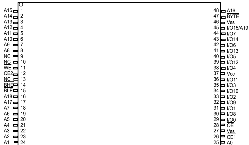
図 5. 48 ピン TSOP I ピン配置 (ERR 付き ( 上面図 )) [3、4]
