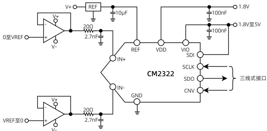
图 27 采用多个电源的典型应用电路
