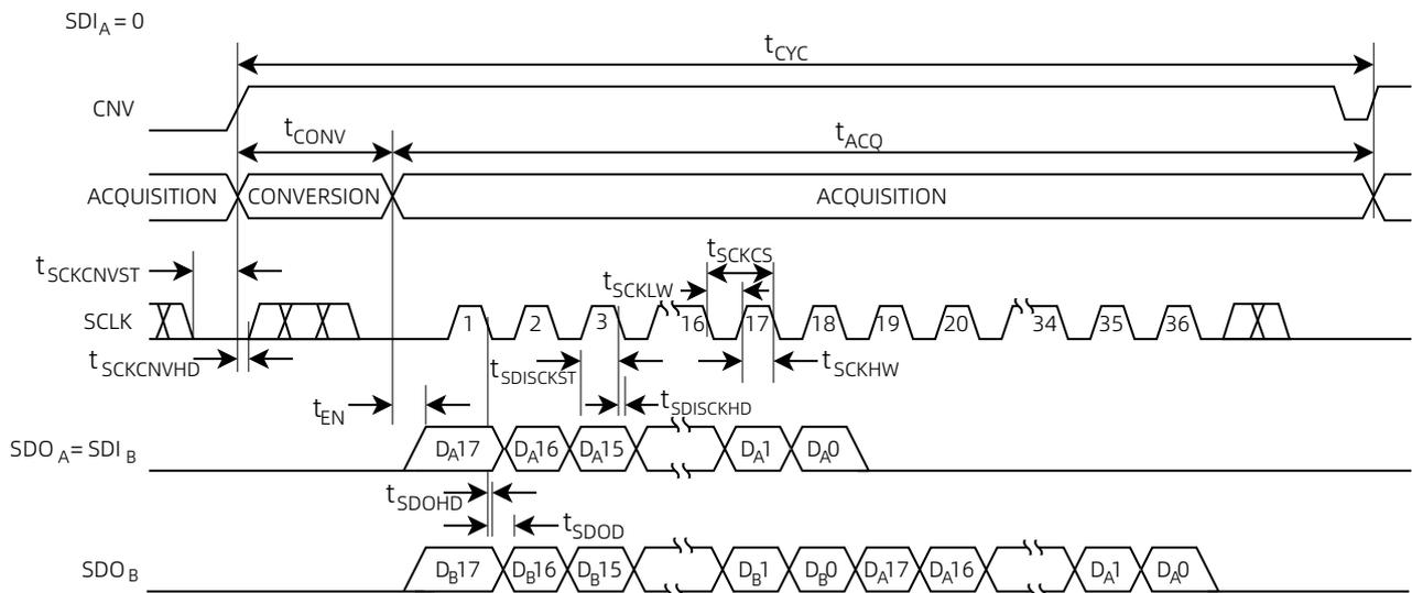
图 5 无繁忙指示串行接口时序 (级联模式)
