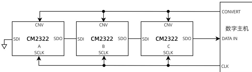
图 25 无繁忙指示连接图 (级联模式)
