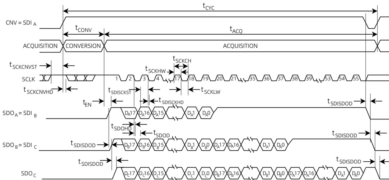
图 6 有繁忙指示串行接口时序 (级联模式)
