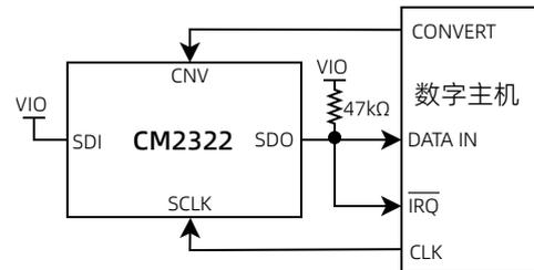
图 22 三线串口有繁忙指示连接图（片选模式）
