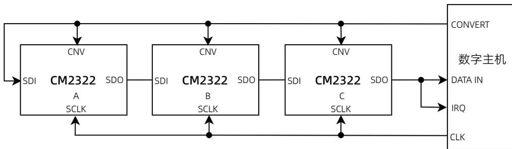
图 26 有繁忙指示连接图 (级联模式)
