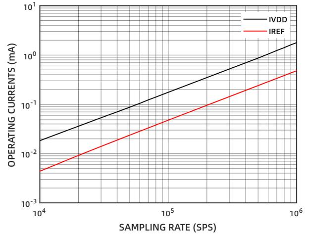
图 20 工作电流随采样率的变化
