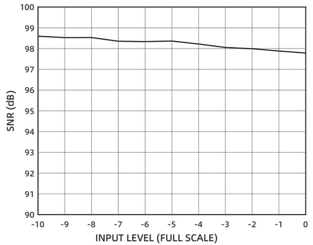
图 10 SNR 随输入电平的变化
