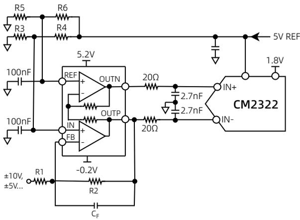
图 19 单端转差分驱动器电路
