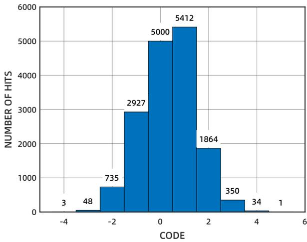
图 9 直流输入直方图 (码中心)
