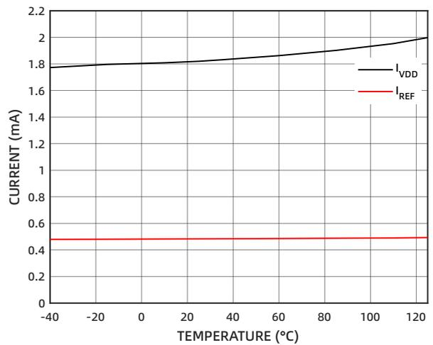
图 12 工作电流的温度特性
