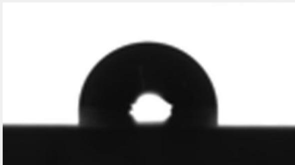
接触角 $95^\circ$ ，有一定的疏水防粘性能
