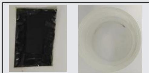
碳钢+涂层，80℃ NaOH溶液浸泡15h
