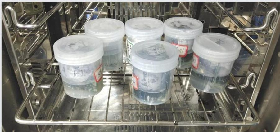
耐碱测试条件：80℃下把样品浸入8%NaOH溶液
