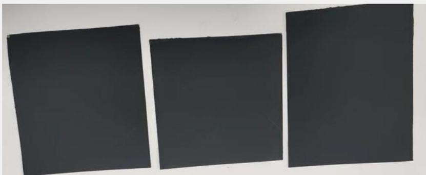
涂层在2%HF中90°C浸泡200h后，外观无任何变化
