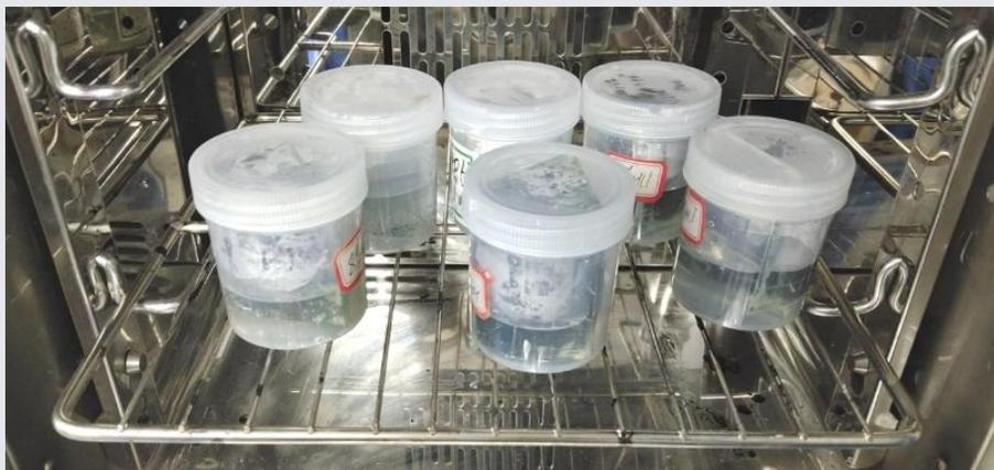
耐酸测试条件：80℃下把样品浸入19%HCl溶液
