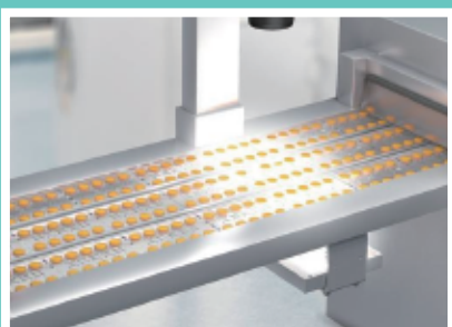
药片损坏情况确认
