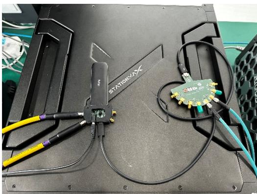
图 4.8 USB3.0 测试链接示意图和实测链接图 4
