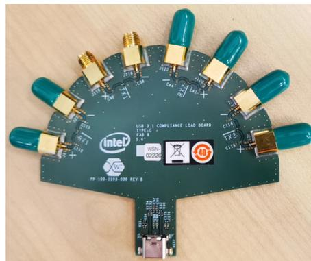
图 4.4 RIGOL USB3.0 一致性测试方案硬件 4
