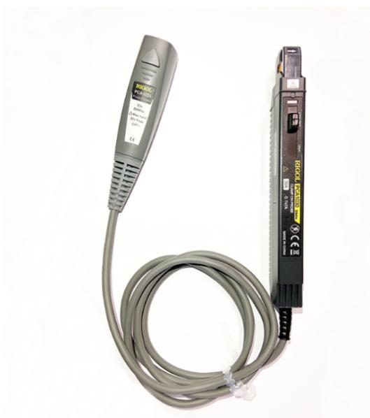
图 4.3 电流探头 PCA1030
