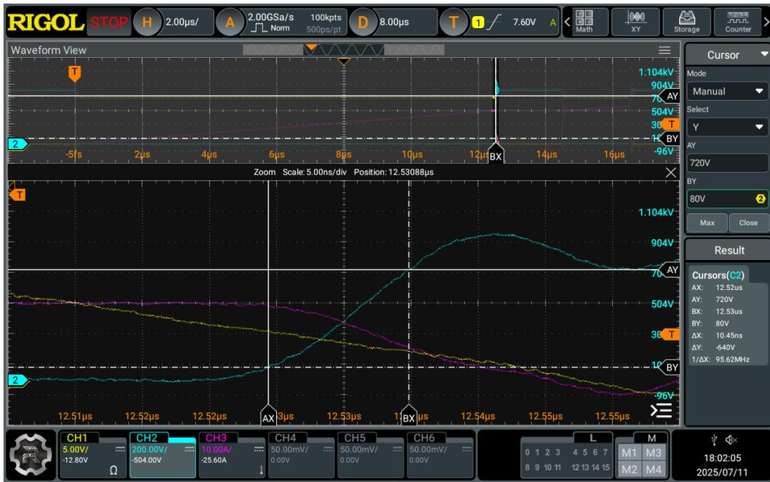
图5 下降时间测试T<sub>off</sub>
