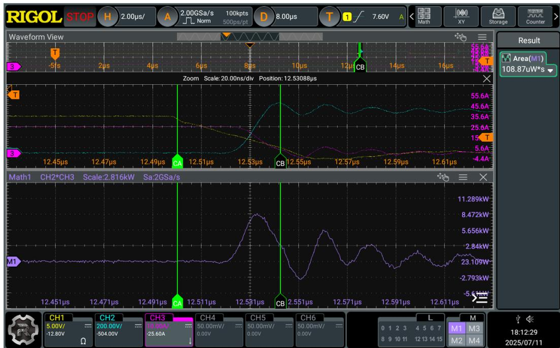
图6 关断损耗E<sub>off</sub>
