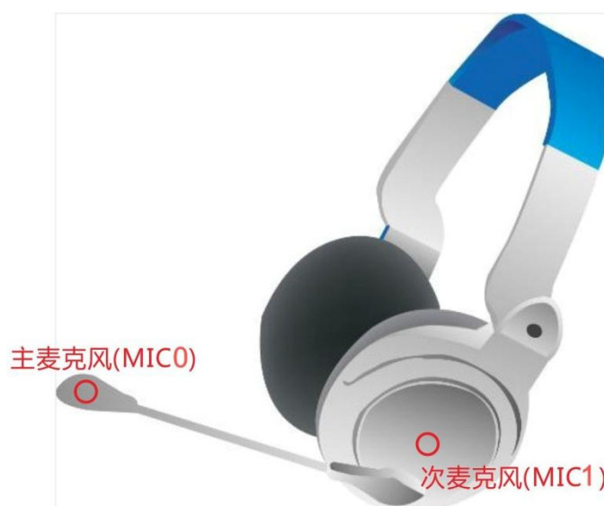
图十七：耳麦产品的双麦降噪摆放图例
