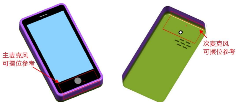
图十八：手机，对讲机等便携产品的双麦降噪摆放图例
