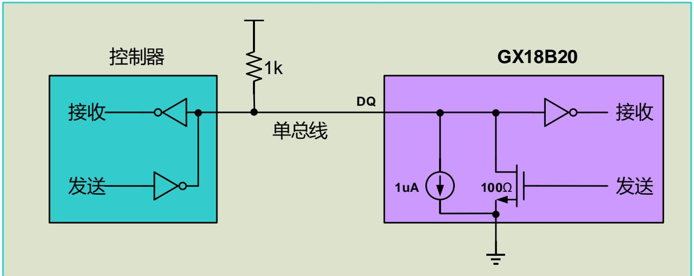
图 10. 硬件结构图
