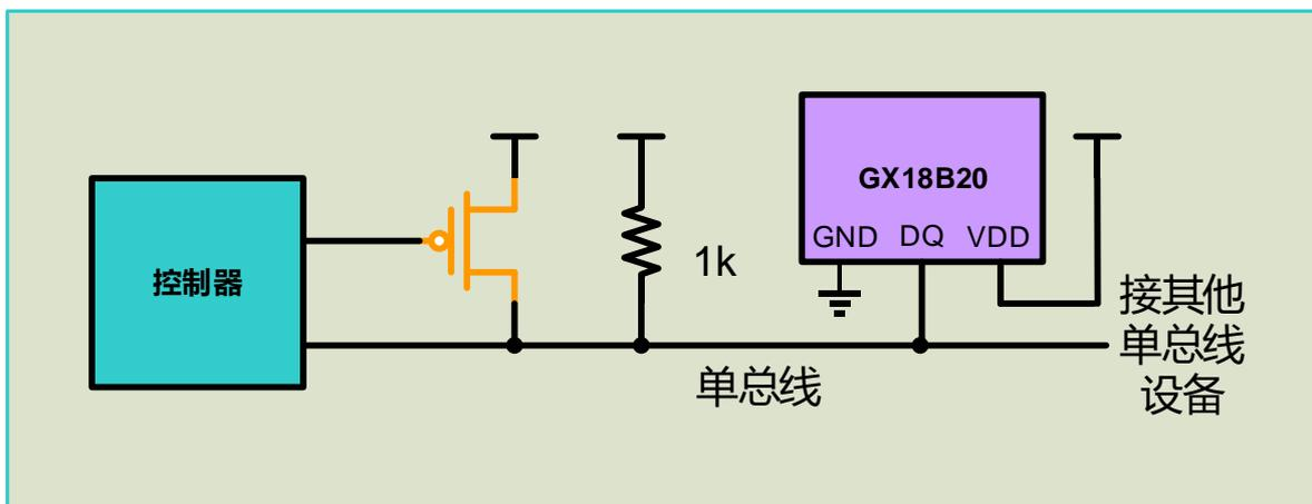
图 5. 使用外部电源为 GX18B20 供电
