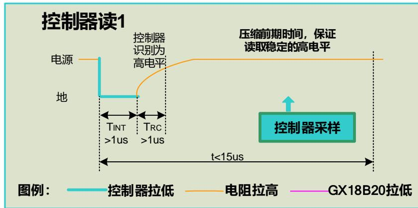
图 16. 推荐的控制读 1 时序
