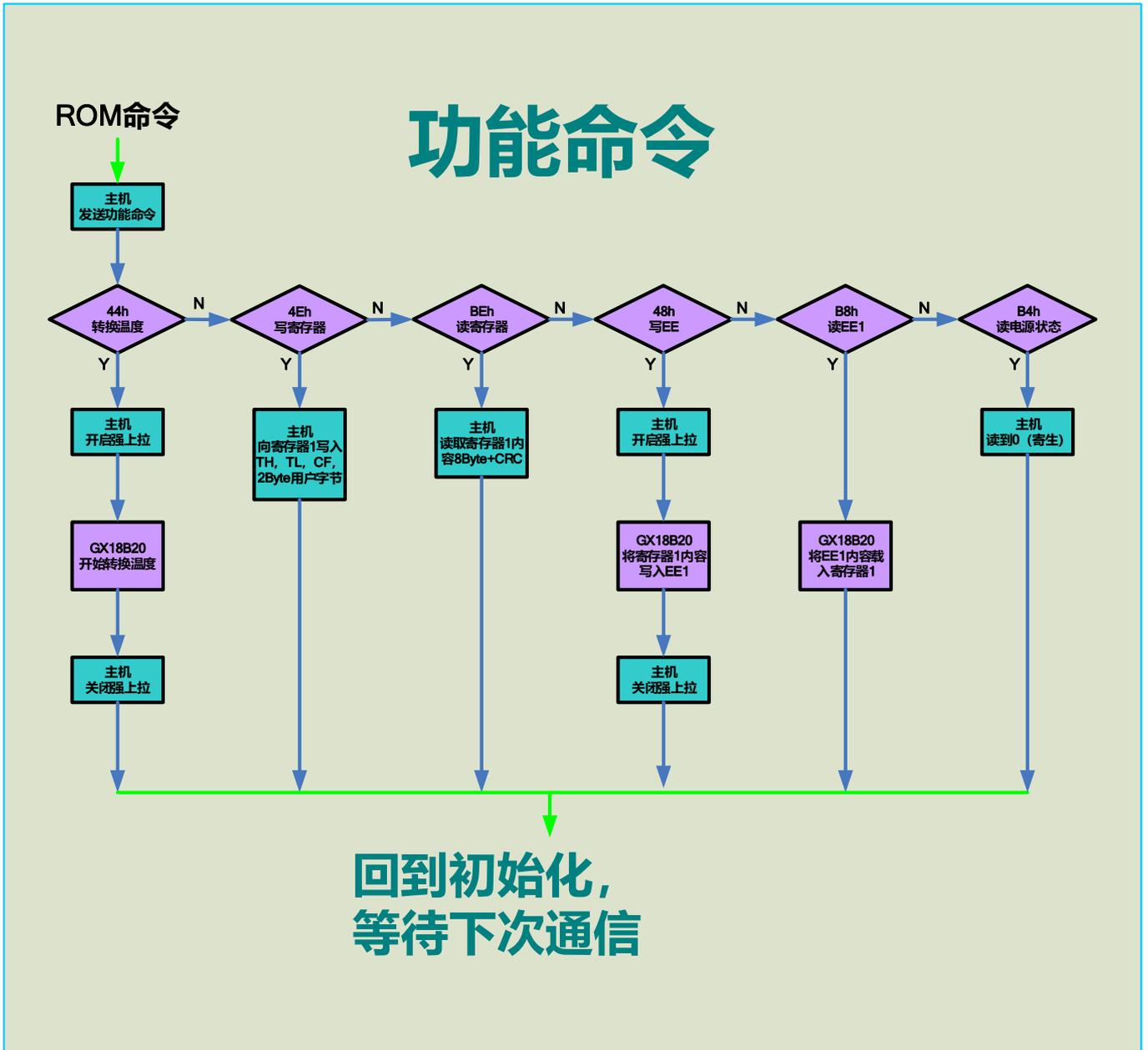
图 12. GX18B20 功能指令流程图
