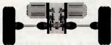
图1 双电机防滑差速驱动系统
