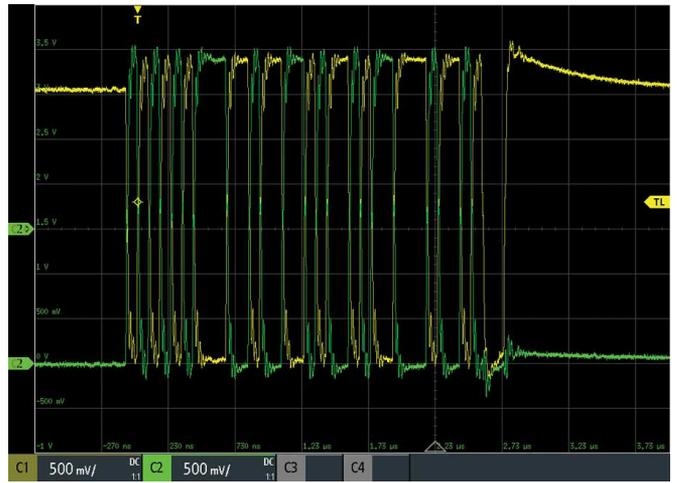
图6. 使用实验室设备捕获的USB信号
