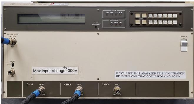
图6. Venable System Model 5060A老式网络分析仪，用于高边浮动噪声注入和LED驱动器的测量。
