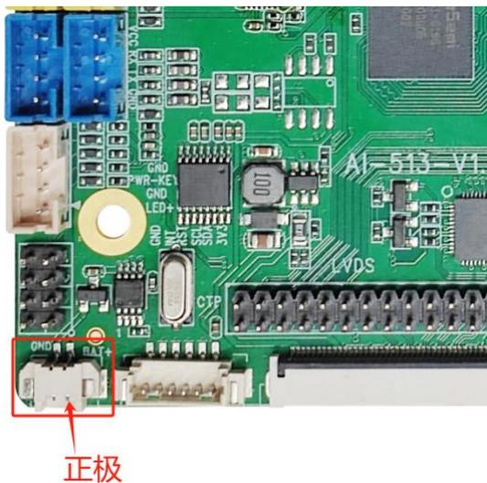
◆ 电源开关按键，LED 灯板接口 (PH2.0 座子)
