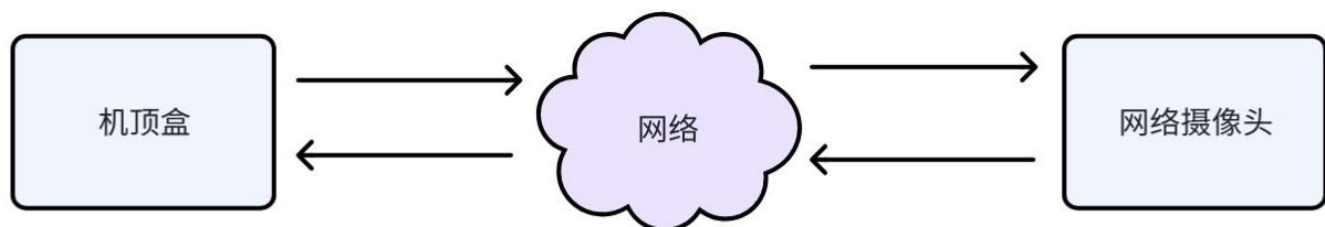
机顶盒安卓应用程序将收到的摄像头视频流经过硬件解码后播放出实时视频
