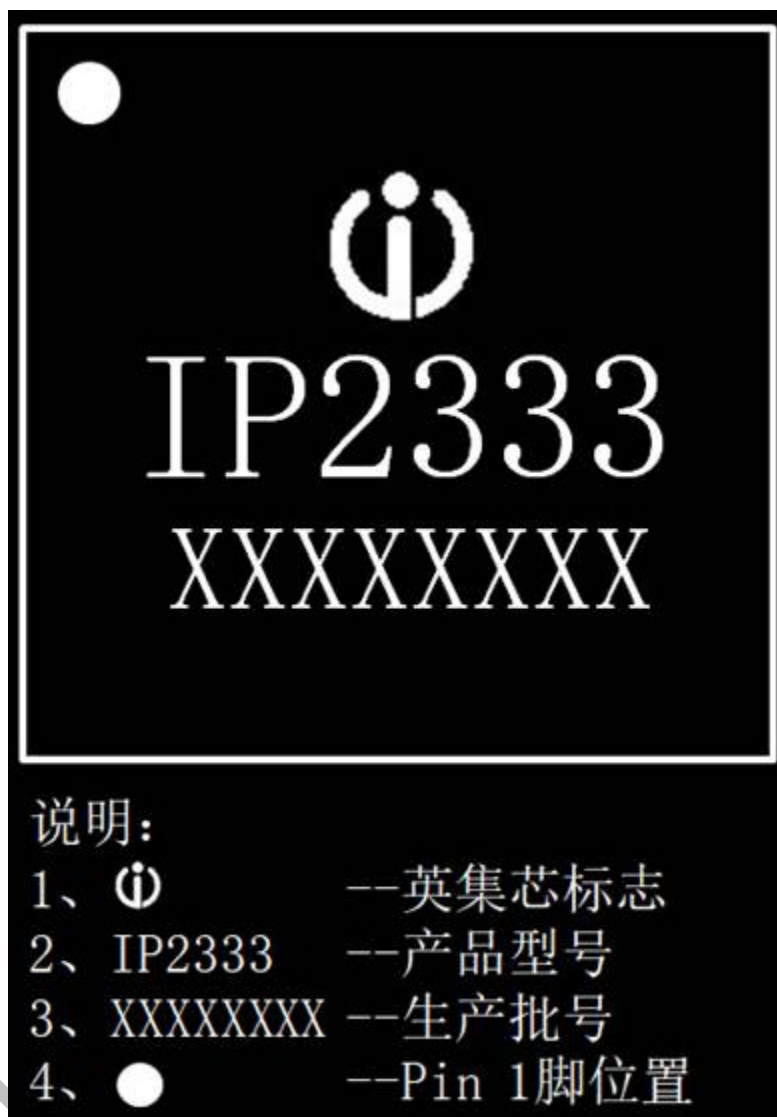
图 14 IP2333 IC 丝印说明
