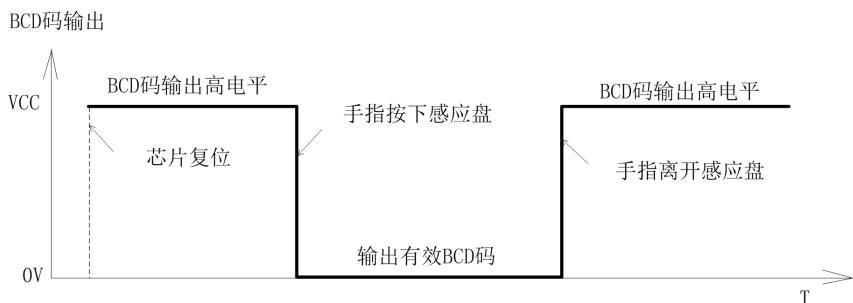
TC315A可以检测多个按键同时有效。但是BCD码输出不能同时输出多个按键值，只能输出当前时刻优先级最高的那个按键。无按键时，BCD[3:0]输出为F。按键优先级由CX0到CX14依次降低。
