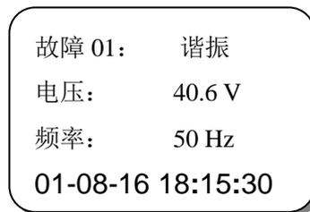
故障信息记录包括故障类型、电压值、频率和故障发生时间。
