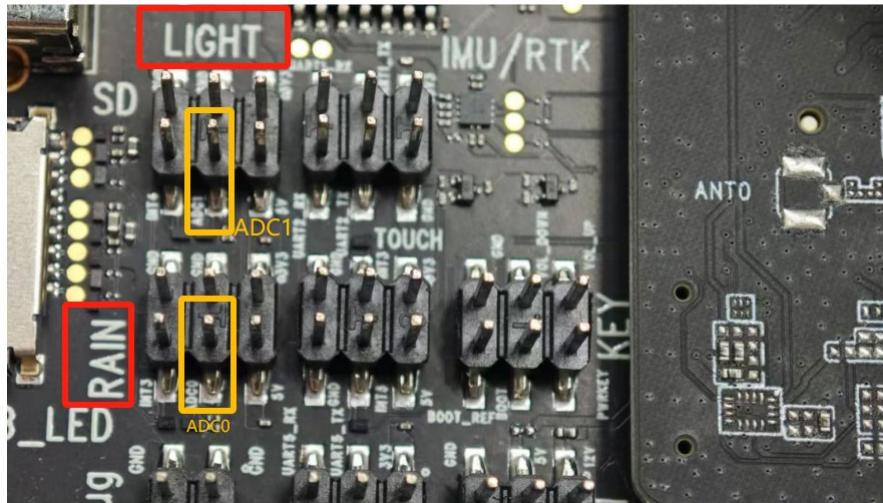
2. 下面使用光线传感器的 ADC1 来进行测试，连接传感器
