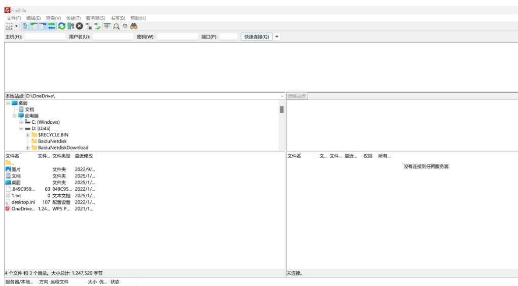
按照下方要求填写，其中主机对应的 IP 地址 192.168.116.221 为上述在 SC171 开发套件 V3 中查询到的 IP 地址，用户需更改为自己查询到的 IP 地址。
