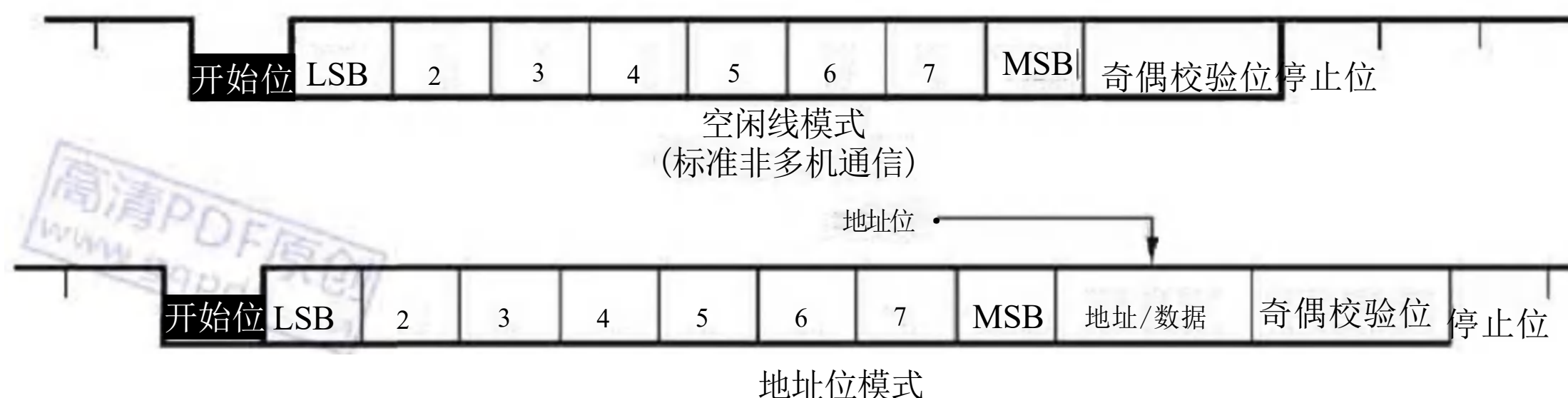
图12.2 典型的串行通信接口数据帧格式
