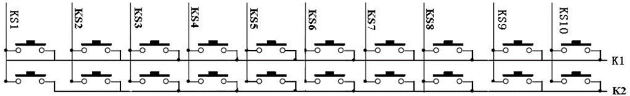
键扫数据储存地址如下所示，先发读键命令后，开始读取按键数据 BYTE1—BYTE5 字节，读数据从低位开始输出，其中 B6 和 B7 位为无效位，此时芯片输出为 0。芯片 K 和 KS 引脚对应的按键按下时，相对应的字节内的 BIT 位为 1。
