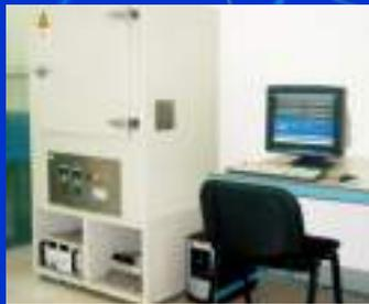
高温绝缘电阻测试仪
