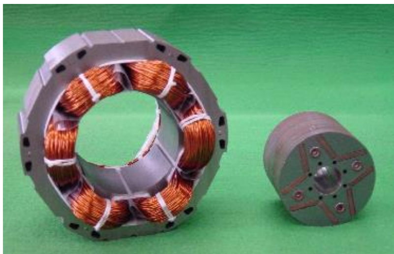
(b) 固定子：集中巻，转子：埋入型／突極型／稀土磁铁
