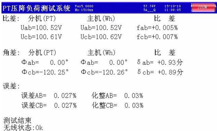
按【确定】重测,【自检】校准,【F4】打印,【存储】保存
