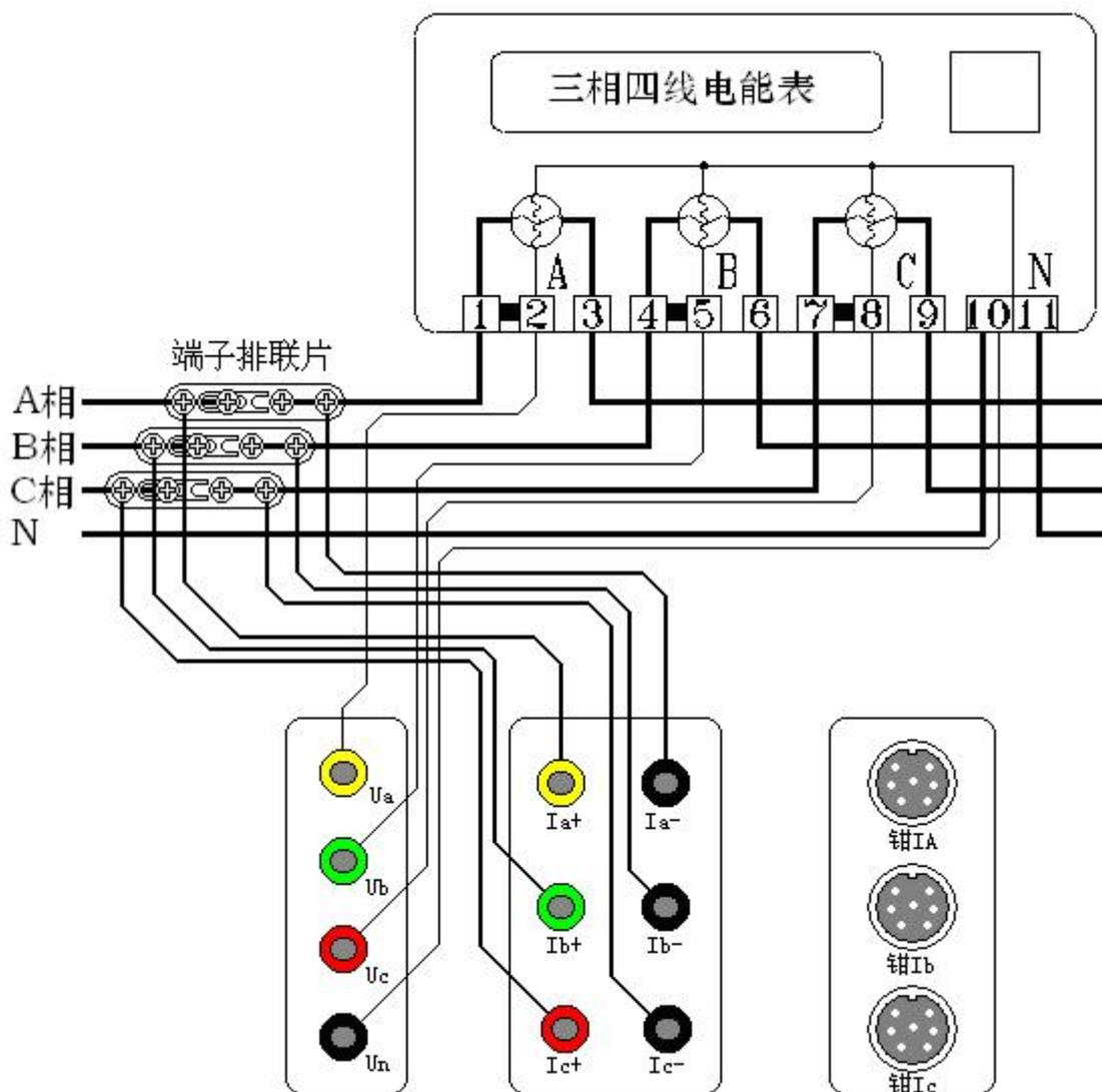
图二十二、三相四线直接接入测试
