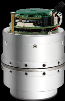
MJA-17 直径: 76mm 重量: <0.95kg 平均负载转矩: 40N·m 额定转速: 30rpm 抱闸: 无
