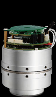
MJB-14 直径: 69mm 重量: <0.73kg 平均负载转矩: 7N·m 额定转速: 32rpm 抱闸: 24VDC永磁式抱闸
