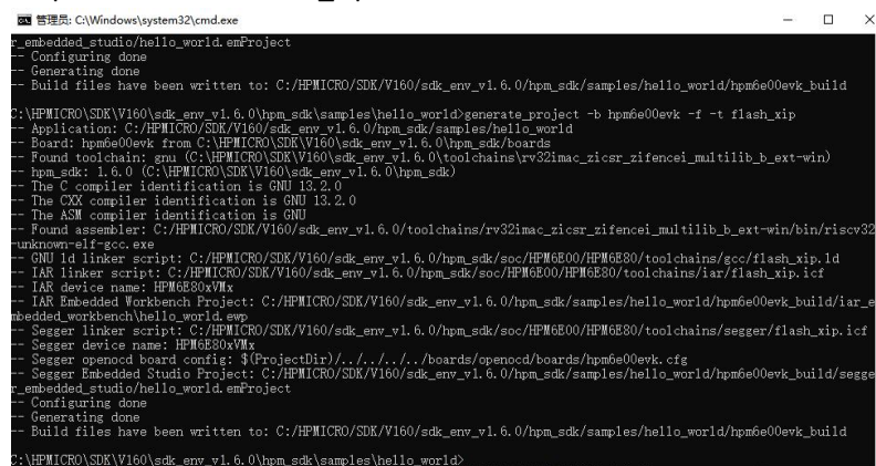
图 10 构建目标板 flash_xip 工程
