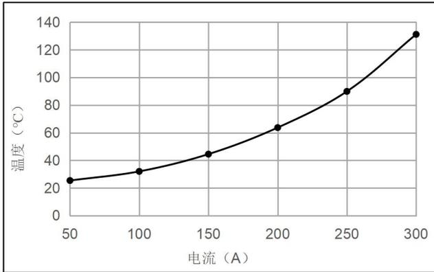
输入电流  $I_P$  vs. 封装体温度
