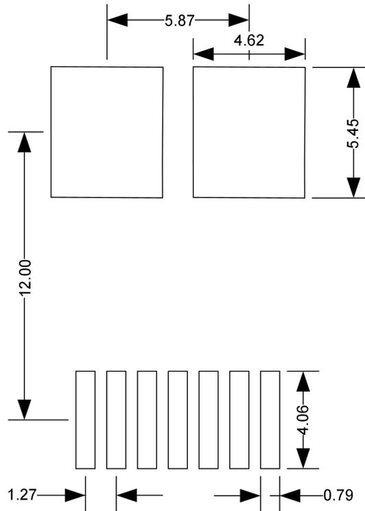
当电流超过 100A 后，推荐焊盘需打孔
