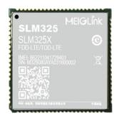
SLM325Y 是美格智能推出的新一代 LTE Cat1 无线通信模组,该模组采用了国产芯片方案,支持最大下行速率 10Mbps 和最大上行速率 5Mbps; 封装上采用了 21.9\*22.9\*2.4mm 的更小尺寸,内置和芯 UC6228 定位芯片,方便客户的设计尺寸需求,丰富的引脚定义,满足客户的多媒体以及 OPEN 开发的需求。
