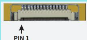
FPC连接器 (15Pin , Pin间距 1.25mm)
