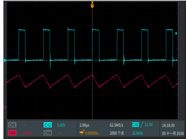
SW 脚与电感电流工作波形
