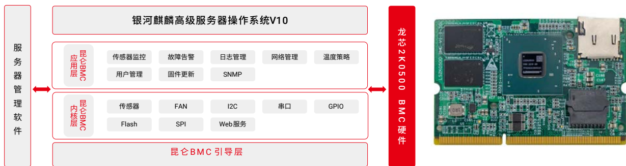
图 4.21 基于龙芯 2K0500 的服务器 BMC 方案
