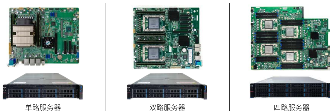
图 4.3 基于龙芯的通用计算服务器
