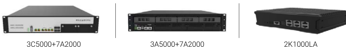
图 4.12 基于龙芯的网络安全硬件平台
