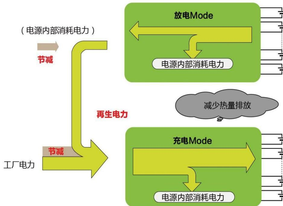
充电模式能量传递：电网→AC/DC双向电源→节能控制电路→电池
