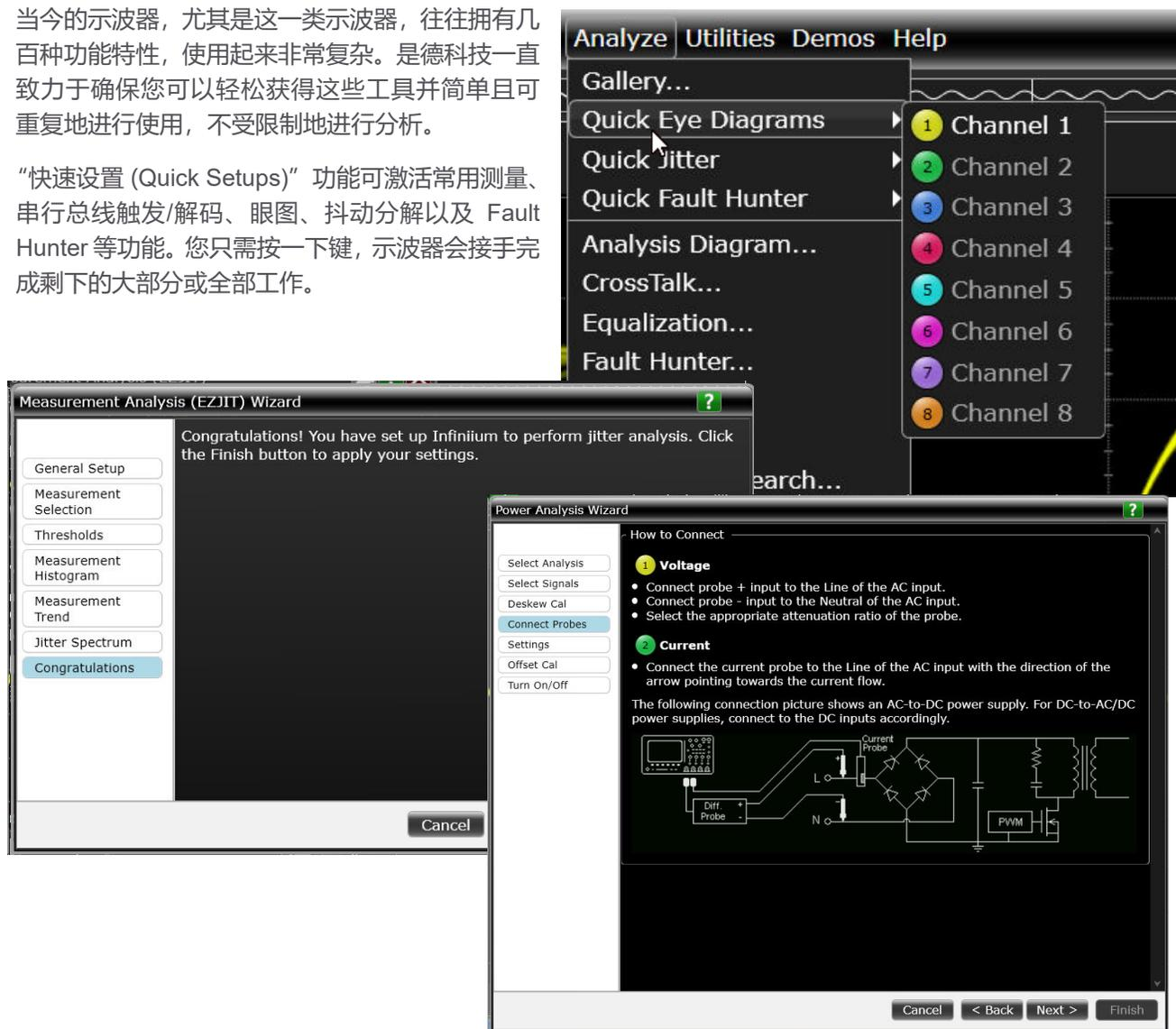
如需进行更复杂的测试，设置向导程序可以为您提供极大帮助。这些分步式对话框会引导您逐步完成细致的分析设置，甚至还会详细解释各种功能特性和设置的意义。您可以通过这些对话框设置电源分析、电源完整性、实时眼图、抖动分解、测量结果分析（趋势、直方图等）以及串扰分析等。
