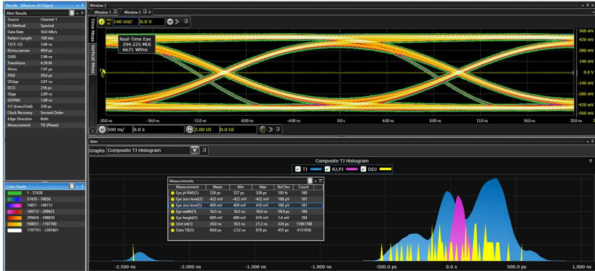
这款软件套件可在垂直（电压）和水平（时间）域中对高速数字接口进行先进的统计分析以及相位噪声分析。上图：完整的实时示波器抖动和噪声分析软件。
