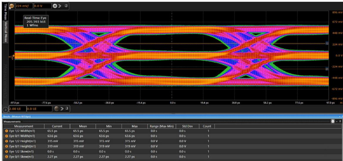
这款软件套件可以快速设置 PAM 编码信号的时钟恢复和测量参数。该软件还能精确设置 PAM 信号的各个阈值电平并渲染每个眼图。它还包含 BER/SER 测量和统计功能。请注意，PAM-3 或 PAM-4 可用于对应应用（除以太网之外）中的信号进行编码，EXR 系列的最高带宽频率为 2.5GHz。
