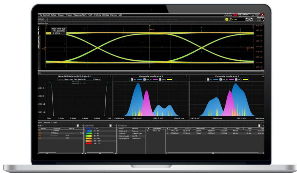
Infiniium Offline 是 Infiniium EXR 系列示波器上提供的一款软件，不需要依赖示波器硬件也能提供同样强大的分析功能。如果您想要从工作位置或家里轻松地远程控制示波器，可以使用主机模式连接并控制一台 EXR 系列，或是运行上面列出的 MultiScope 应用软件，控制多台 EXR 系列。如果示波器的使用受到限制，您可以在自己的示波器上捕获波形，并保存到文件中，然后在 PC 上运行 Infiniium Offline 软件，调用波形进行后期分析。除此之外，该应用软件还支持不同示波器厂商的多种常用波形格式。现在，您可以随时随地在电脑上查看、分析、共享和记录示波器测量结果。型号参见本文末尾部分的配置指南。
