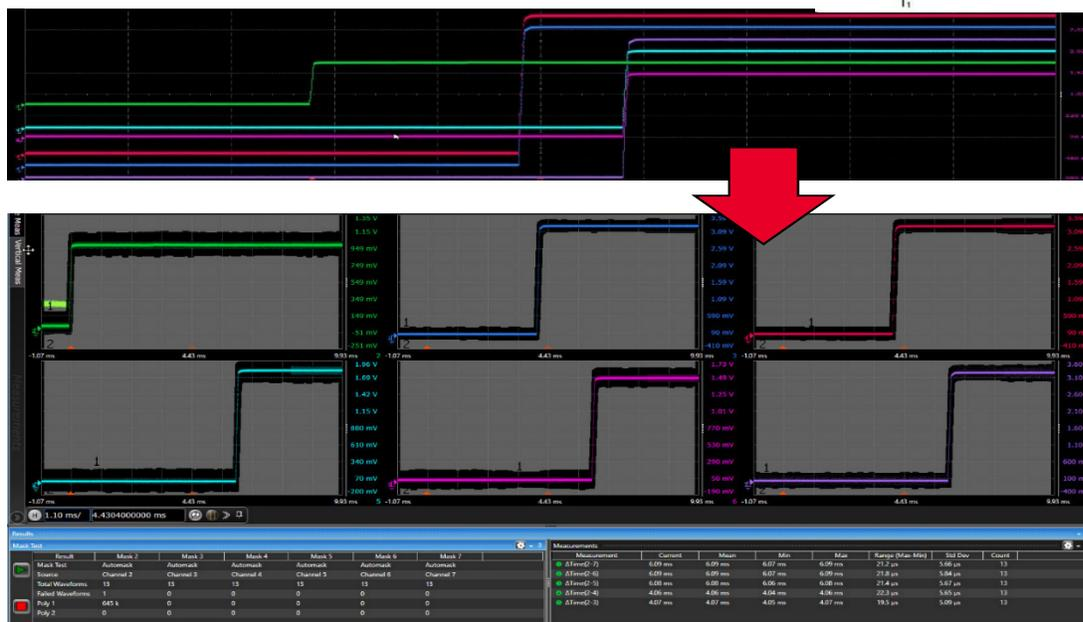
通过将波形分置于不同屏幕分区并在每个通道上进行独立的模板测试，您可以在成千上万个启动周期中对这六个电源轨进行连续测试。请注意用于生成单次屏幕快照测试报告的模板测试和测量结果在屏幕上是如何显示的。
