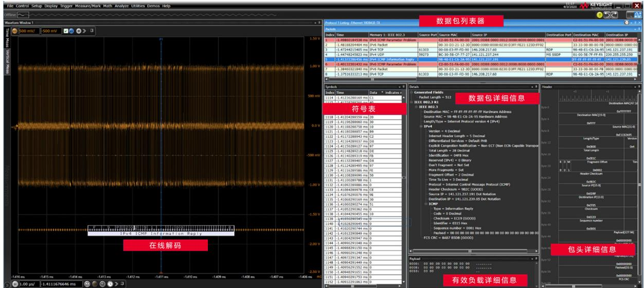
使用协议触发和解码套件，您可以轻松调试和测试数字设计，此应用软件针对每种串行总线都提供了丰富的综合协议级触发。当选中串行触发之后，此应用软件就可以启用示波器内置的串行实时触发硬件。硬件触发可以确保示波器在工作中不会错过任何触发事件。该硬件使用由示波器或数字通道采集的信号来重建协议帧，然后根据指定的协议级触发条件来检查这些协议帧，一旦符合条件便进行触发。请浏览关于此套件的网页和技术资料，了解更多信息—本文“配置指南”部分列出了可以使用的触发和解码功能。您也可以考虑 D9011BDLP，它支持数十种协议触发和解码功能，而价格适中，订货方便！
