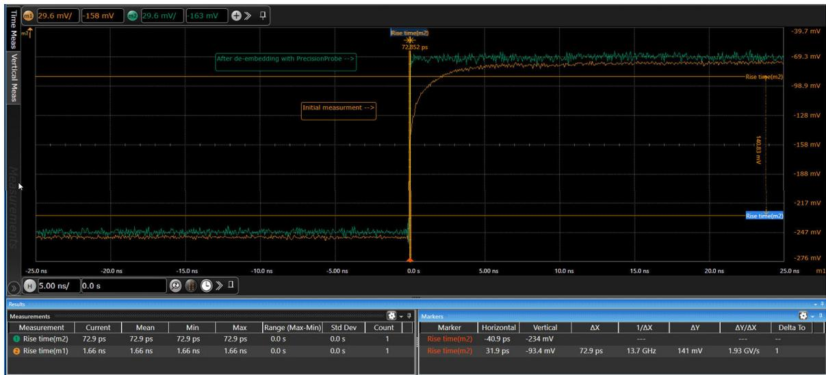
这款软件套件包括 PrecisionProbe 和 InfiniiSim Basic 两个工具，可以去除电缆和夹具对测量结果的影响。您可以使用 PrecisionProbe 表征探头、电缆或夹具的响应，并使用 InfiniiSim 建立这些响应的模型并从测量结果中去除。
