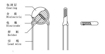
包封层(Coating) : 环氧树脂(Epoxy Resin)
