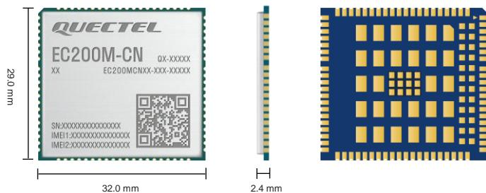
移远通信 EC200M-CN 是一款专为 M2M 和 IoT 领域而设计的 LTE Cat 1 无线通信模块，支持最大下行速率 10 Mbps 和最大上行速率 5 Mbps，具有超高的性价比。同时，在封装上兼容移远通信 LTE Standard EC200x 系列（EC200N-CN 和 EC200A 系列）、EC2x 系列和 EG2x-G 系列以及 UMTS/ HSPA+ UC200A-GL 模块，可实现不同网络间的无缝切换。
