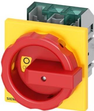
SENTRON, 隔离开关 3LD5 UL, 急停开关, 3 极, 经过认证 UL 489、UL60947-4-1 和 IEC60947-3, UL: 30A, 480VAC 时 SCCR 50kA, 额定功率 @ 480VAC 3 相: 20hp, IEC: 32A, AC-23A 时的额定功率 400V 时: 15kW, 前面已固定: 旋转驱动, 红色/黄色, 4 孔固定手柄, 包含端子盖用于馈电侧
