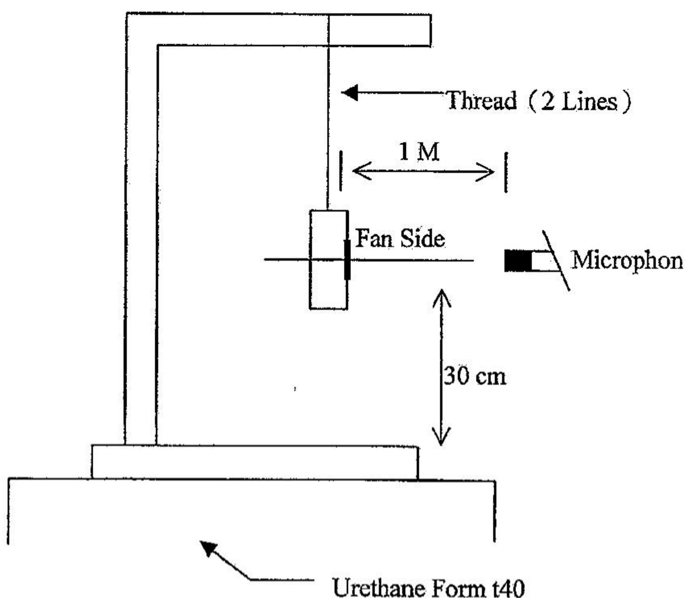
1 METER FROM MICROPHONE TO FAN INTAKE
