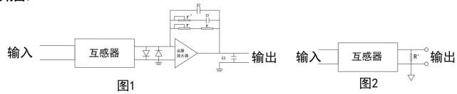
电流型系列电流互感器,典型应用电路如图 1 所示:
