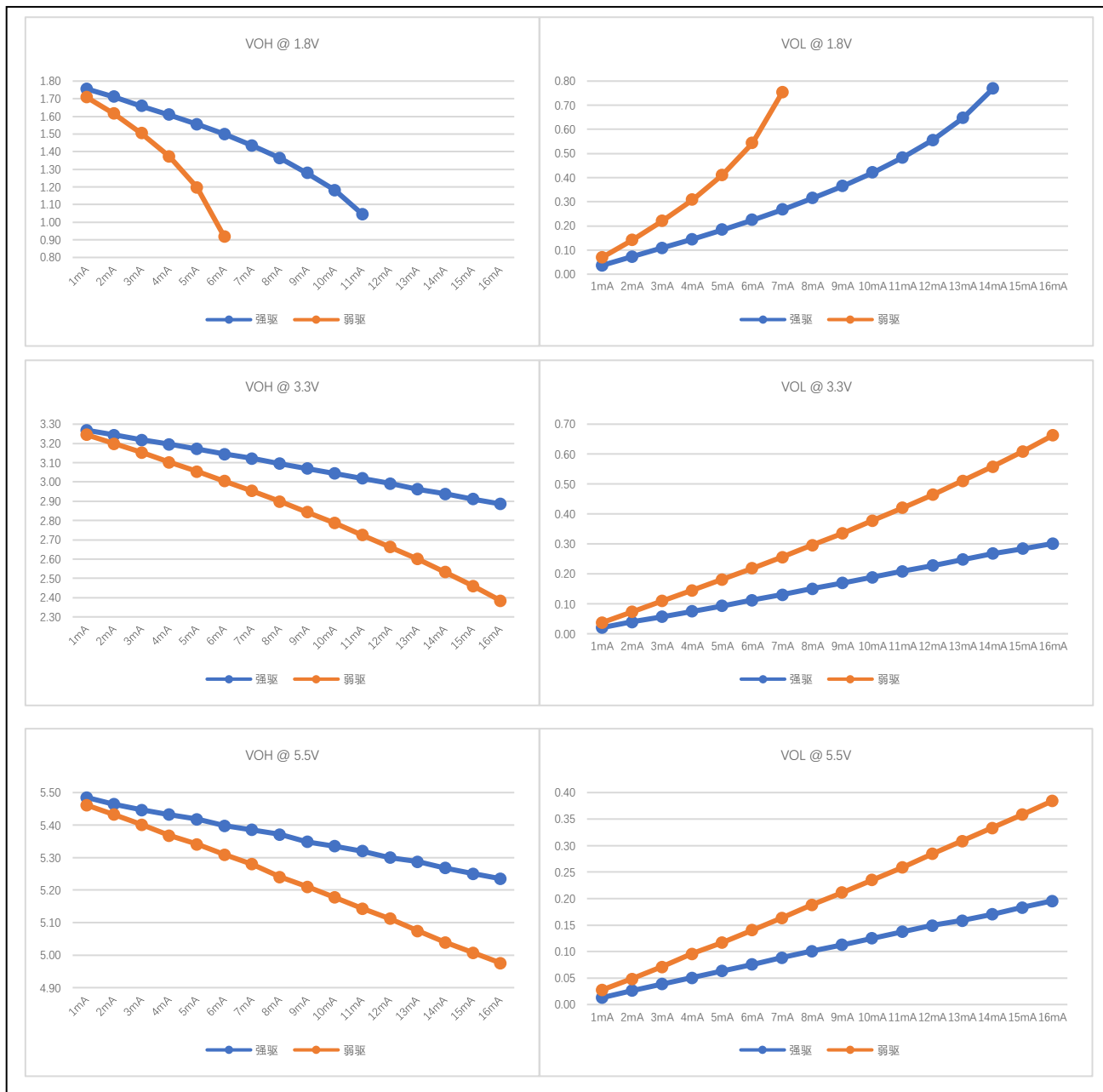
图 7-2 输出端口 VOH/VOL 实测曲线
