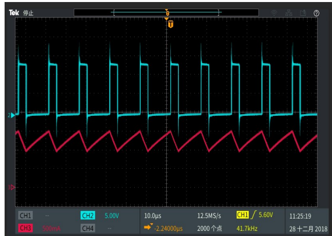
SW 脚与电感电流工作波形
