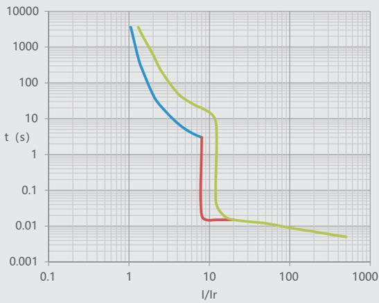
图6 NM1LE-125 32A-63A 温度补偿曲线
