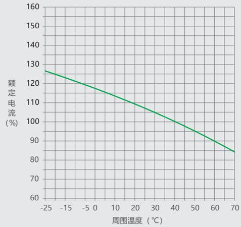
图17 NM1LE-400 配电保护
