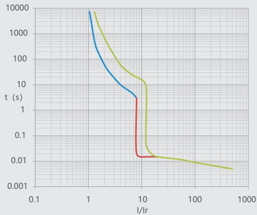
图14 NM1LE-250 温度补偿曲线
