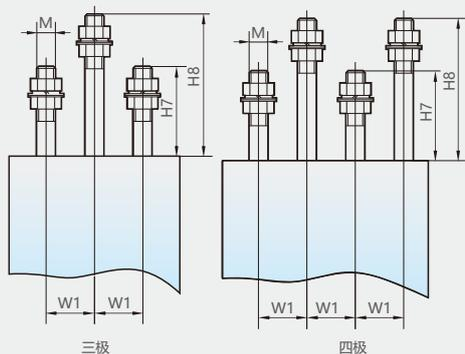
NM1LE-400, 630, 800板后接线(外形及安装尺寸见表14)
