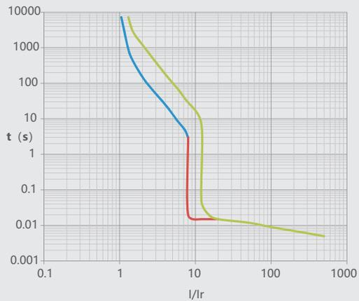
图26 NM1LE-800 温度补偿曲线
