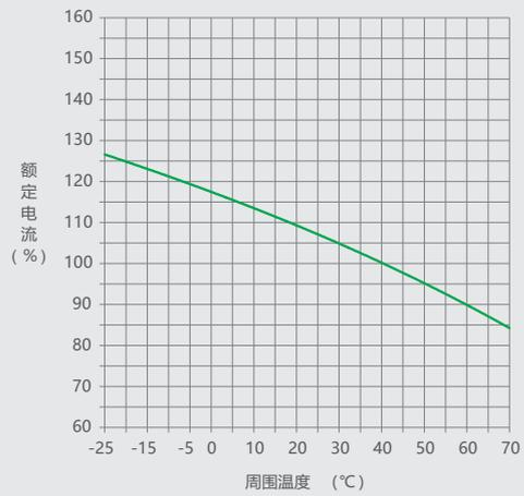
图9 NM1LE-125 >63A 配电保护
