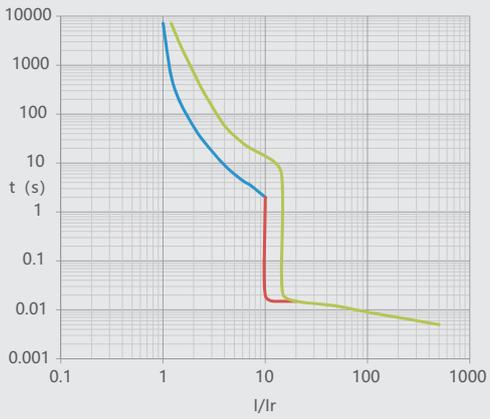
图16 NM1LE-250 温度补偿曲线
