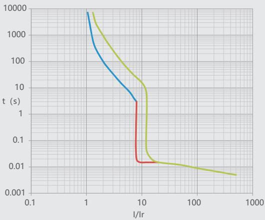
图18 NM1LE-400 温度补偿曲线
