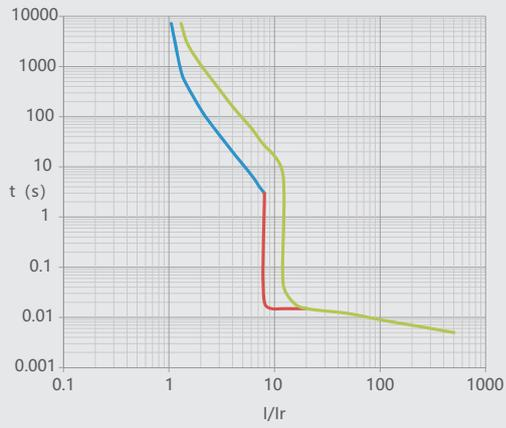
图22 NM1LE-630 温度补偿曲线
