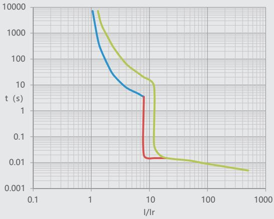
图10 NM1LE-125 >63A 温度补偿曲线
