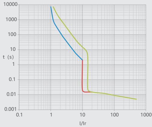
图24 NM1LE-630 温度补偿曲线
