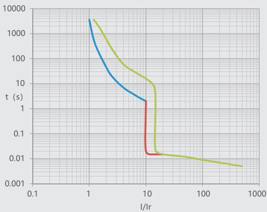
图8 NM1LE-125 32A-63A 温度补偿曲线
