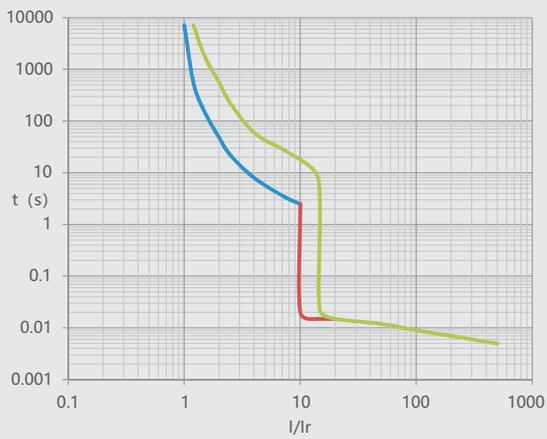
图12 NM1LE-125 >63A 温度补偿曲线
