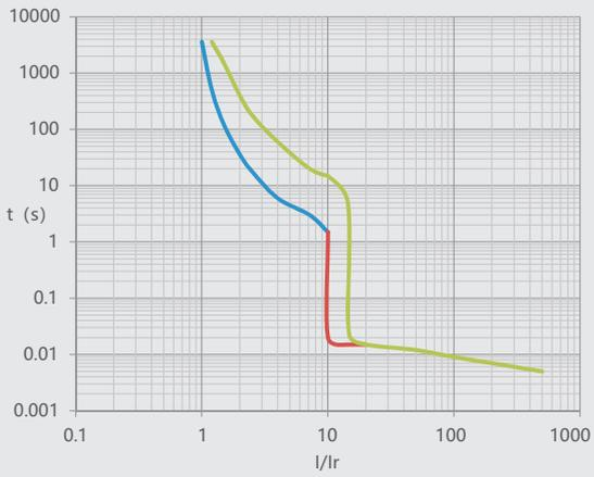
图4 NM1LE-125 16A-25A 温度补偿曲线
