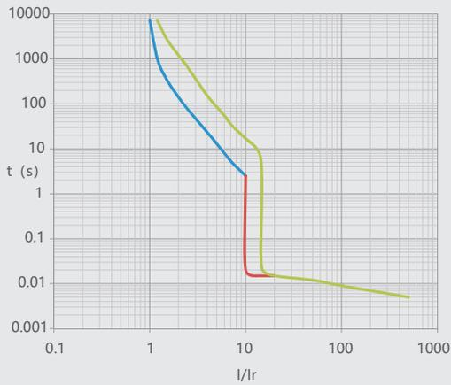
图28 NM1LE-800 温度补偿曲线
